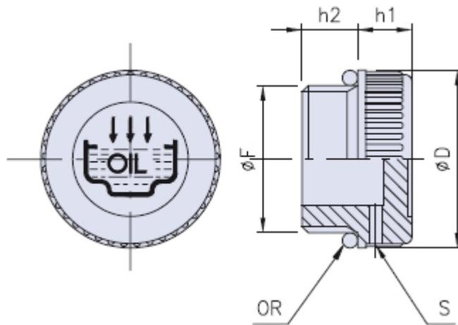
S = Entlüftungsbohrung
